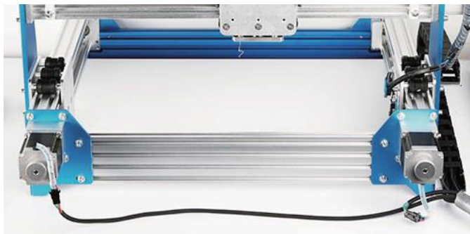
Y2 zum linken Motor und Y1 zum rechten Motor
